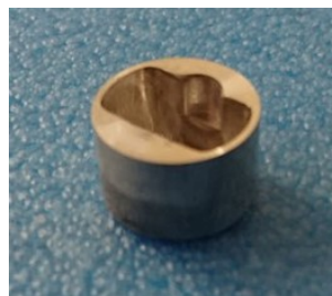
インパクト成形による試作品の一例
