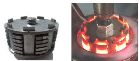
試作した治具 熱処理の様子
