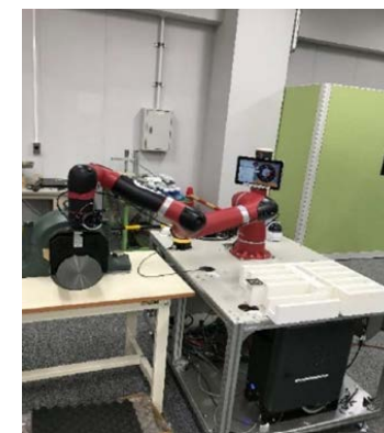
フレキシブル型協働ロボットによる部品交換作業
