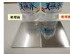
特許第 7029742 号 電解研磨液及びそれを用いた ステンレス鋼の電解研磨方法
