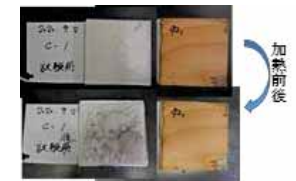
加熱前後の木材の比較・700℃で20分加熱後も木材に変化がないことが確認できた
