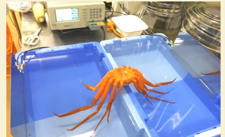
交流電気抵抗を利用した ベニズワイガニの選別技術
