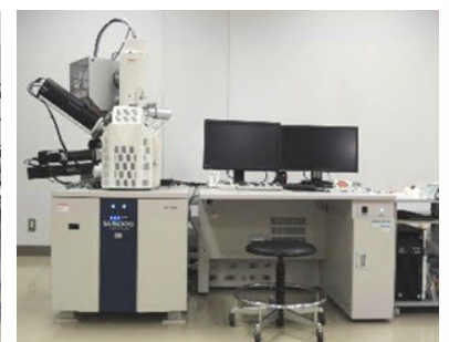
金属組織観察用機器 左：レーザー顕微鏡、右：電子顕微鏡
