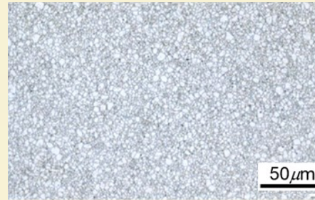
繰り返し高周波焼入れによる 低合金鋼組織の微細化
