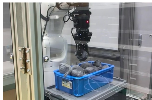
図2 ランダムピッキングテストの様子
