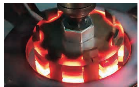
磁束密度制御用治具を用いた焼入れにより 自動車部分野への参入を支援
