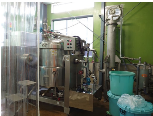
導入された真空濃縮装置（左） アスタキサンチン含有油（右上）と カニ殻ナノペースト（右下）
