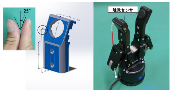
図 25 人の指を模擬した触覚センサ搭載ロボットハンド
