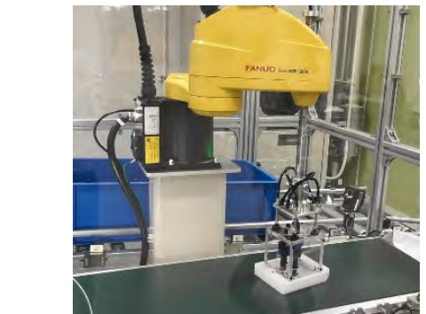
高速型スカラロボットによるトラッキングの検証
