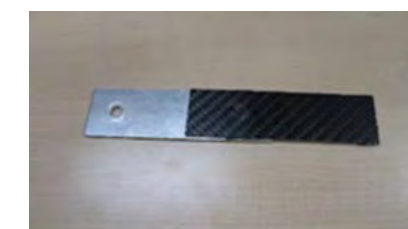
接合後の試験片 (左:アルミニウム、右:CFRP)
