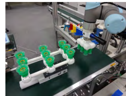
高精度型協働ロボットによる動作制御とピッキングのためのハンドの検証
