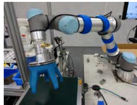
高精度型協働ロボットによる動作制御とピッキングのためのハンドの検証
