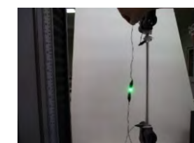
導電性インクを塗布したシリコーンゴムの導通性試験
