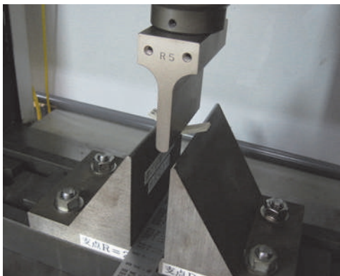
図3 曲げ試験外観
