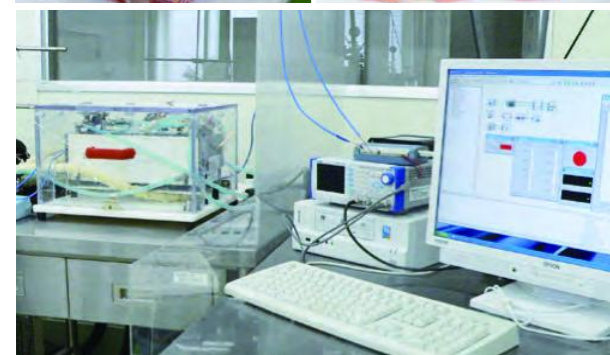
大型成型化した魚肉と通電加熱装置
