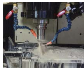
マシニングセンターによるドリル性能試験
