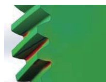
FEMによる応力解析結果。「はすば歯車」のような複雑な形状の製品に対してもFEMを用いれば応力や変位を計算することができます。
