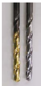
左:窒化チタンコーティング 右:コーティングなし
