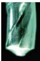
高速度カメラ サーマグラフィ シミュレーション ライフリング現象解明により穴壁面粗さを向上
