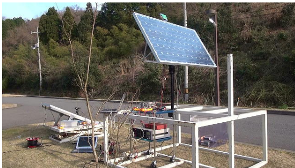
図4 太陽光追尾装置と測定環境の全景
