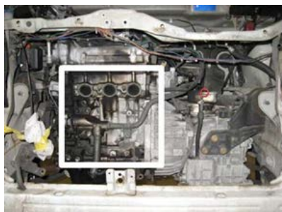
図6 (b) エキゾーストパイプ取り外し後
