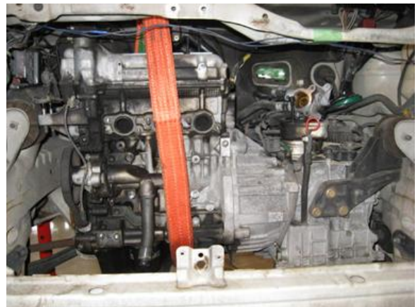
図7 エンジン取り外し作業
