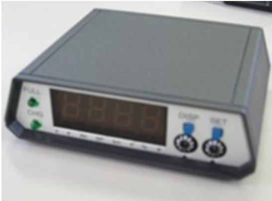
図3 バッテリー計測装置
