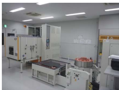
支援事例 13 の振動試験装置
