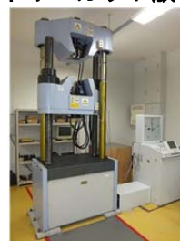
18 強度評価で使用した万能材料試験機
